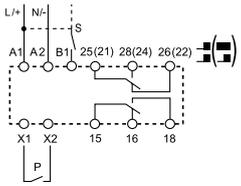
**U** = Betriebsspannung    **S** = Startkontakt    **P** = Pausekontakt    = Schaltzustand des Schließers
